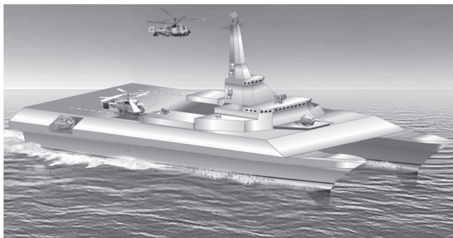
Figure 16 External view of an S/P SWATH frigate Slika 16 Vanjski izgled poluglisirajuće SWATH fregate
