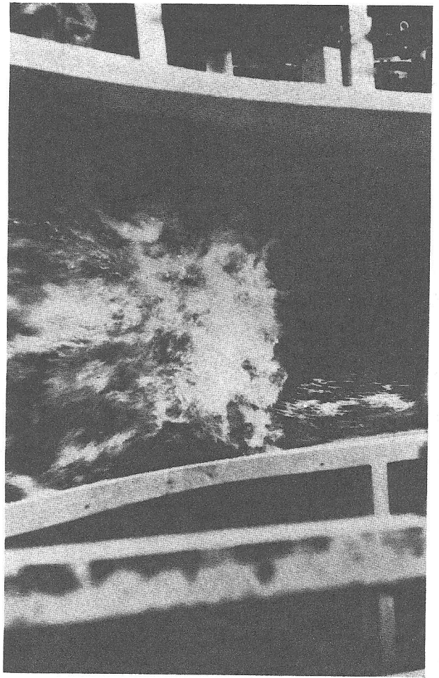
Bild 26. Schwallbildung bei Katamaran-Modell U-55 (Blick von oben auf das Hinterschiff; Strömungsrichtung des Wassers von rechts nach links)
