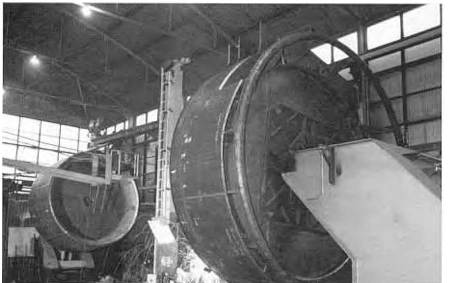
Fig. 6. Automatisch aflassen onder poederdek op lasmanipulator. (Foto Van der Kloet, Sliedrecht).
