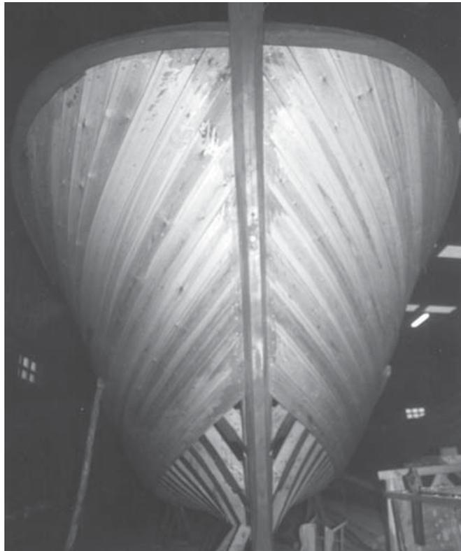
Figura 85.- Disposición de *bances* manteniendo el ancho.
