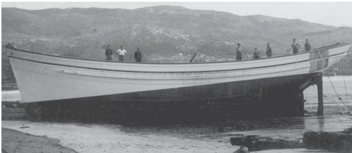
Figura 155.- El «*Coneso*» construido en 1948, varado después de la botadura. En el costado de la zona de popa se distingue la defensa dispuesta para proteger el forro del arte en la zona de recogida. Se trata de una baka.
