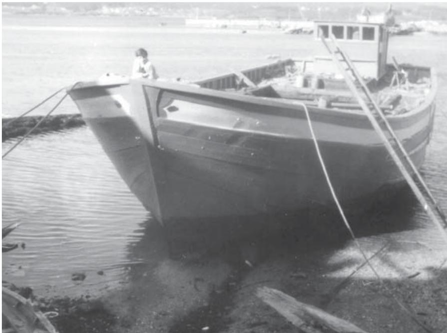
Figura 144.- Gabarra para transporte de arena.
